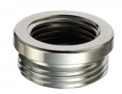
Filettatura femmina Filettatura maschio Pressione di **Portata BSPP** 24 l/min ( $\Delta P = 0.3$  bar con **BSPP** utilizzazione otturazione), 33,5 l/min ( $\Delta P$ G 3/4 G 1/2 0 a 10 bar = 0,3 bar senza otturazione) Ø di passaggio Materiale Temperatura -15°C a +60°C Corpo ottone nichelato 9 mm
